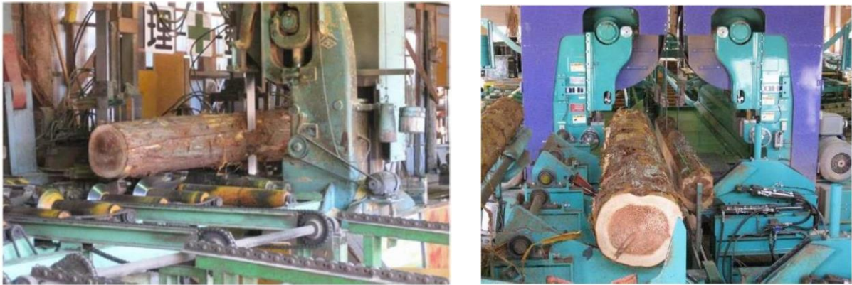
図表 9-1 大径材対応製材機（左：送材車付き帯のご盤、右：ツインバンドソー）
