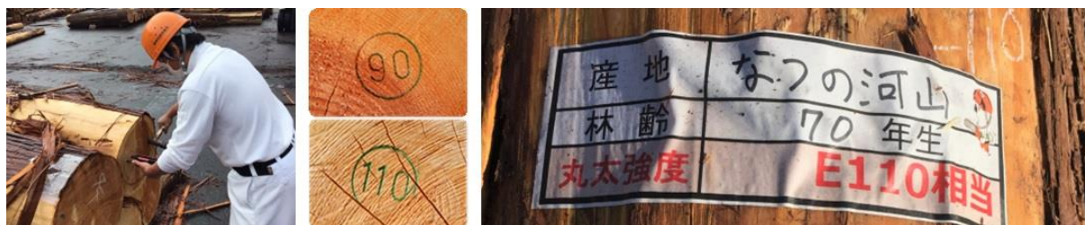
図表 7-3 原木の強度測定(左)と強度表示(中央・右)(資料: 田辺地域)
