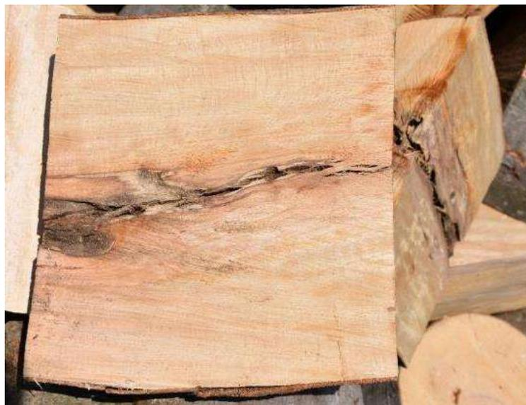
クワカミキリが産卵し、孵化後、幹の中心部を食べ進んだ孔が穿孔材。その孔を伝って木材腐朽菌が侵入し変色したのが偽心材
