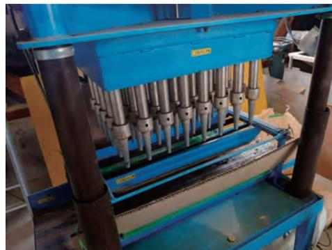
写真6-12 攪拌、充填、穴あけまでできる培地充填機(上:日本森林技術協会、中央・下:島根県 提供)
