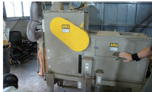
写真6-15 篩選と風選が一体となった穀物用の精選装置(林木育種センター 業務資料より)
