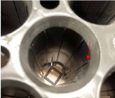
写真2 コンテナ内壁のリブ構造
