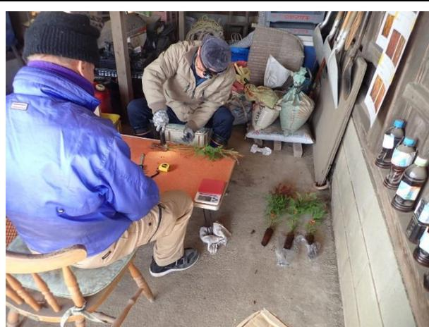
写真 4-2 根鉢の硬度測定風景
