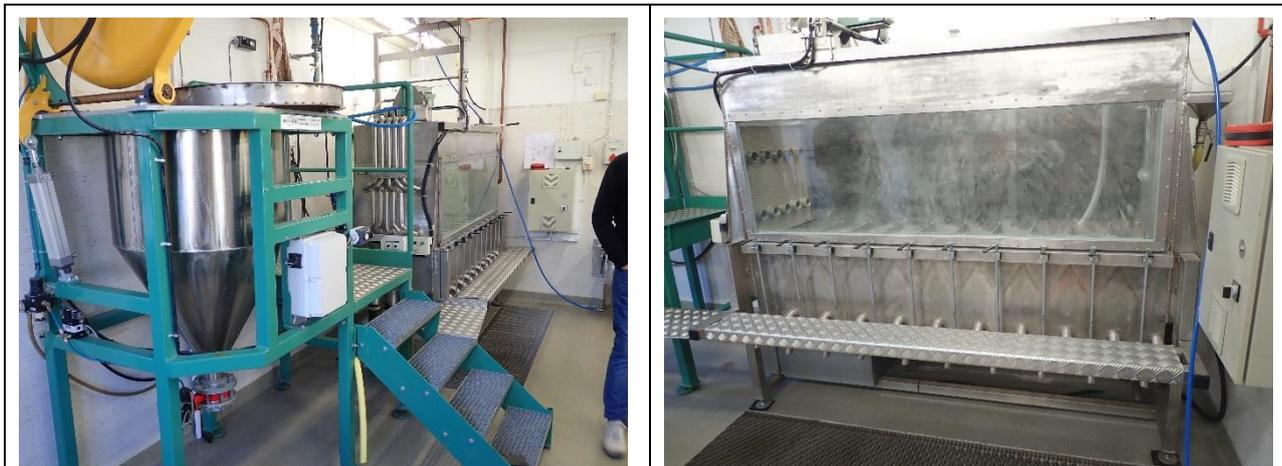
IDS 法（湿式種子選別法）による選別装置。左のドラムで種以外の不純物を取り除き、右の装置に水を入れて、左から右に流す。沈んだ種が充実種であり、沈んだ順番でグレードわけをしており、左に沈んだ種のグレードが高い。
