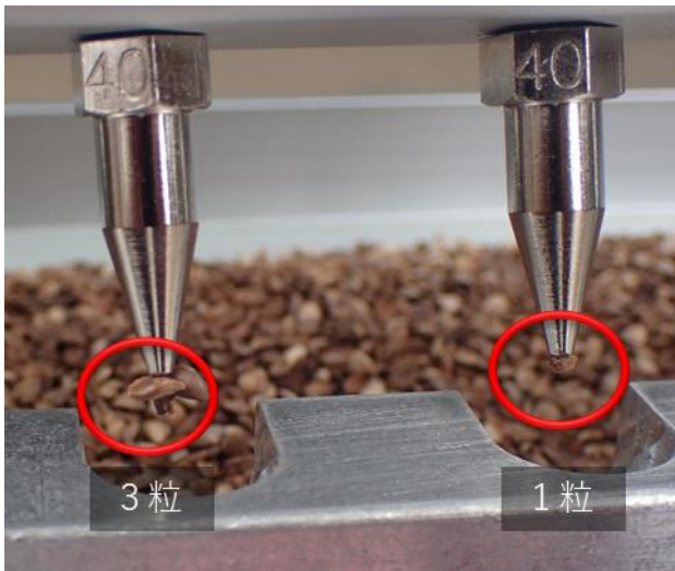
写真 6-29 播種機のニードルが種子を吸い取る様子
