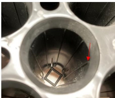
図 11 リブコンテナの内壁面 赤矢印はリブを示す。
