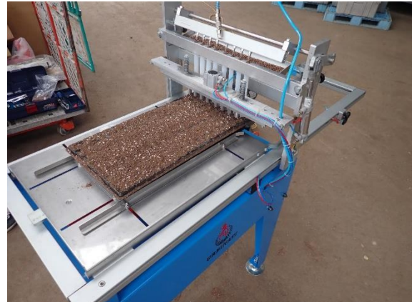
写真 6-7 播種板を使用したキャビティ 1粒播種作業
