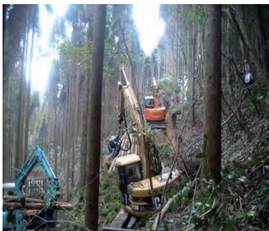
写真-13 完全並列作業システム
