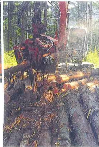
木材の枝払い、測尺、玉切りの作業を連続的に行えるプロセッサ
