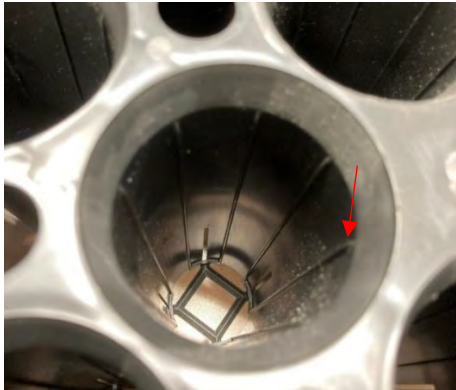
写真2 コンテナ内壁のリブ構造 赤矢印はリブを示す。
