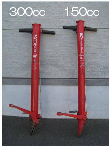
先端が閉じた状態で土壌に差し込み、ペダルを踏んで先端を開けたのち、上部から苗木を落とし込むことで植付ができる。屈みこむ、腰を曲げるといった動作が不要なことから、労力負担が少ない。
