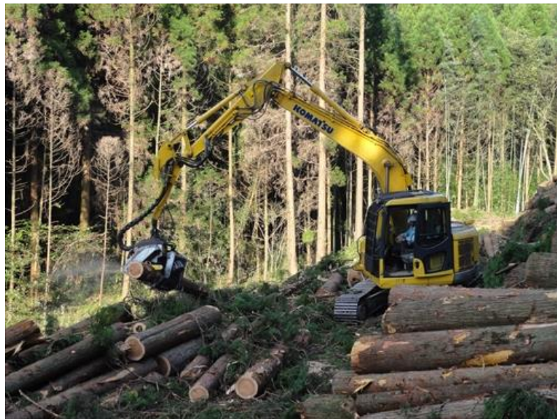
②プロセッサによる造材作業状況
