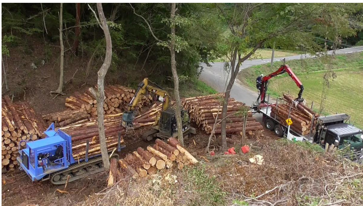
写真 4.2-7 グラップルによる積み下ろし・極積み
