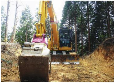
写真 3.3-1 フェラー付きグラ ップルバケットローダー（ウイン チ付き）
