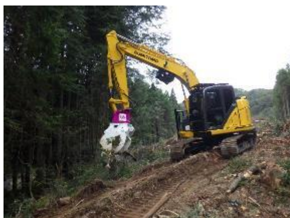
写真 4.2-8 フェラー付きグラップルバケットローダー (左) 及び人力 (右) による地拵え
