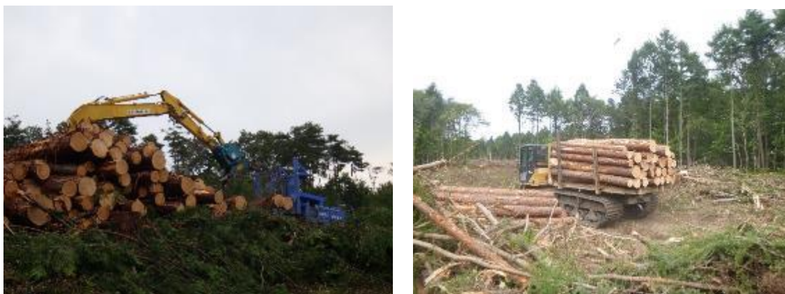
写真 4.2-6 グラップルによる積み込み（左）、フォワーダによる搬出（右）
