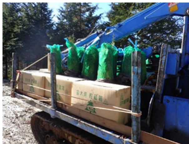
写真 2.2 フォワーダによるコンテナ苗の運搬
