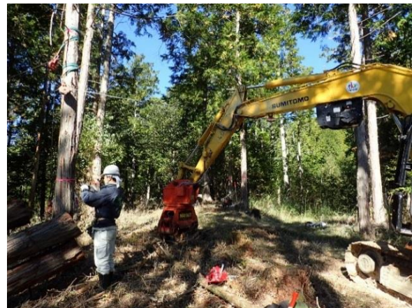
ウインチを利用した簡易架線集材
