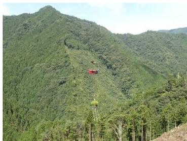
架線系機械による苗木運搬
