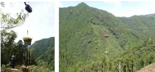
架線系機械による苗木運搬
