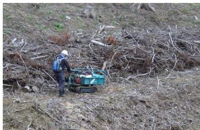
クローラ運搬機による運搬作業
