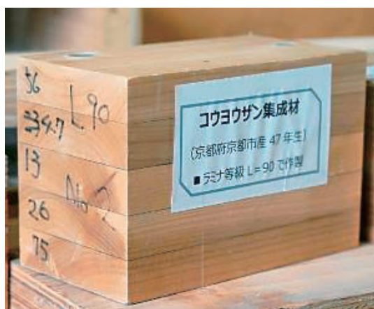
写真12 ラミナ等級L90で作製されたコウヨウザン集成材
