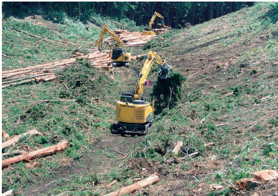
写真1 グラップルによる地拵え作業
