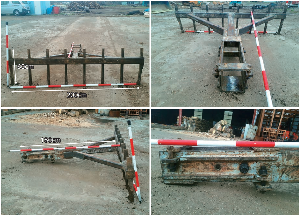
写真5 南佐久北部森林組合型レーキ (左上から前面、後面、側面、固定部) 紅白ポールの間隔は20cm
