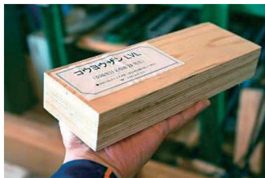
写真11 25年生で作製されたLVL スギのLVLと同程度の強度がある
