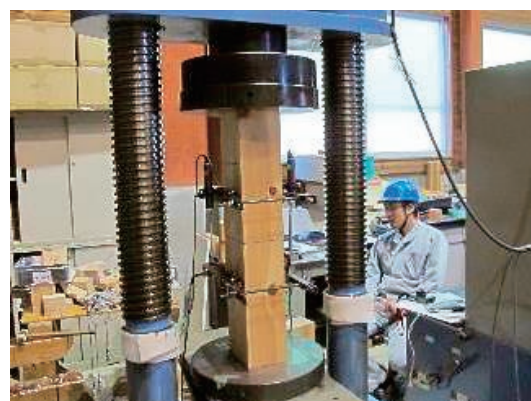
写真7 縦圧縮強度試験
