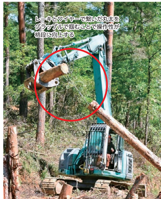
写真6 レーキとワイヤーで繋いだ丸太を掴むことで、グラップルの操作性が格段に向上
