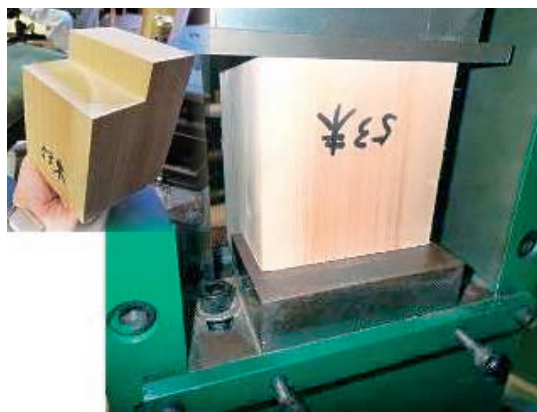
写真8 せん断（実大いす型）強度試験
