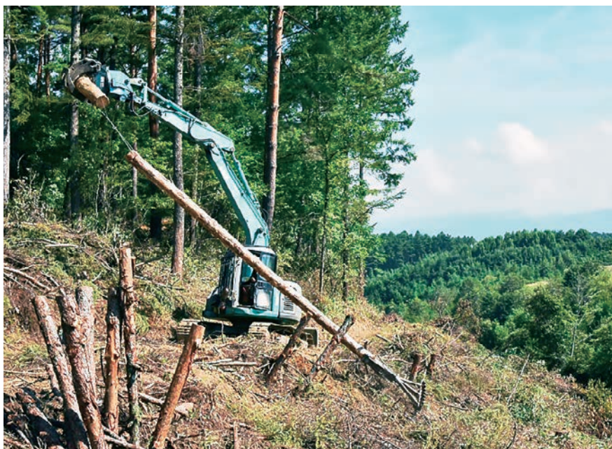
写真1 急斜面での機械地拵えに対応したグラップルレーキ
