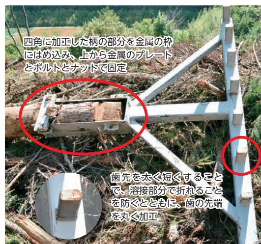
写真3 改良ポイントとしては、歯の先端を丸く加工することと、柄の部分に金属で挟み込んで固定している点である
