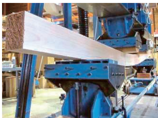
写真6 曲げ強度試験
