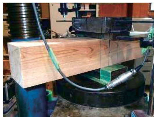
写真9 めり込み強度試験
