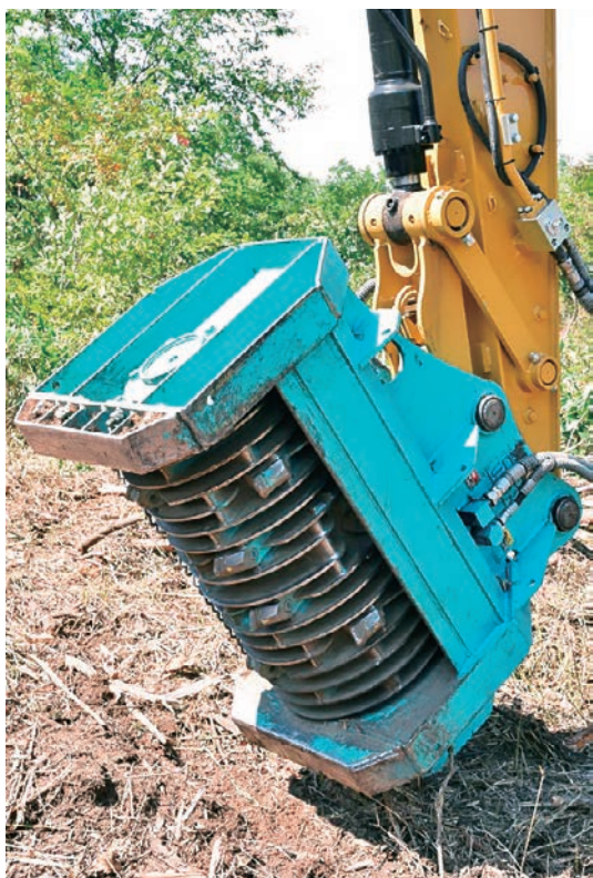
写真8 切削刃（A型刃）を装着した破碎ローター
