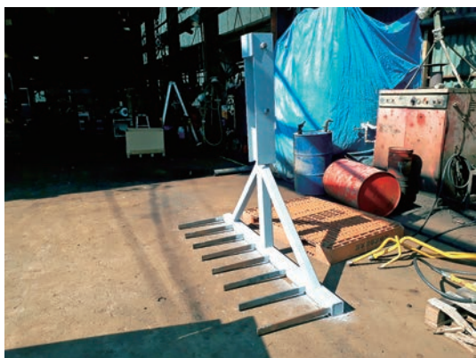
写真2 第1号機 歯が細く長く歯先の角は鋭角になっている
