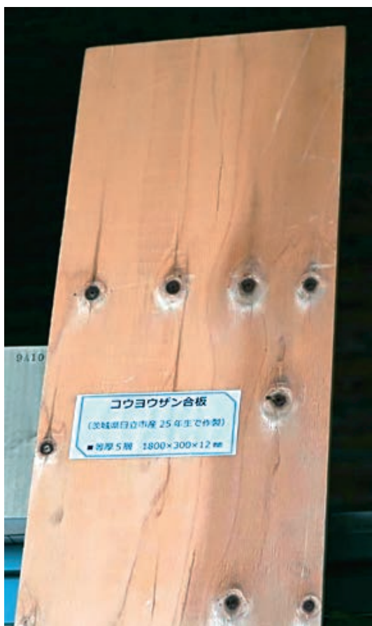
写真10 JAS構造用合板2級相当の利用が期待できるコウヨウザン合板
