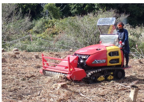
写真 1 乗用型多目的造林機械
