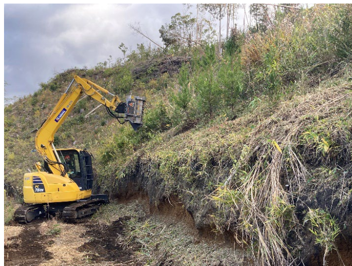
写真 16 7トンクラスベースマシンにマルチャーを装着した機械下刈り風景
