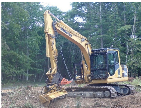
写真 9 刈刃アーム装着型機械（マルチャー装着）で地拵えする様子
