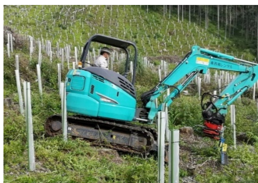
写真 14 ベースマシンに装着したヘッジカッターで下刈り作業 (提供：大分県庁)
