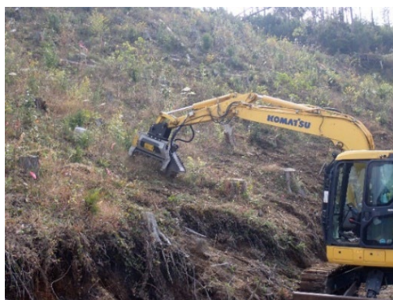
写真 3 マルチャーアタッチメントを使用した下刈り作業
