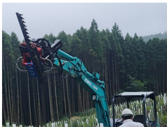
写真 4 ヘッジカッターアタッチメントを装着した下刈り機械
