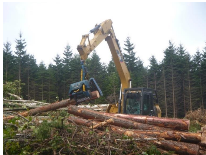
写真 5-3-5 ハーベスタによる造材
