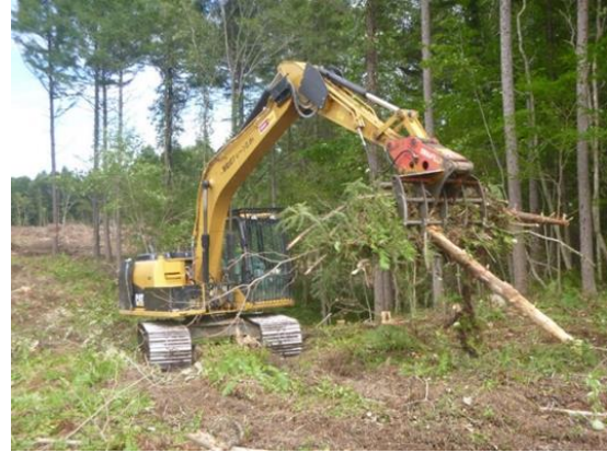
写真 5-3-8 グラップル（左）及びグラップルレーキ（右）による地拵え作業
