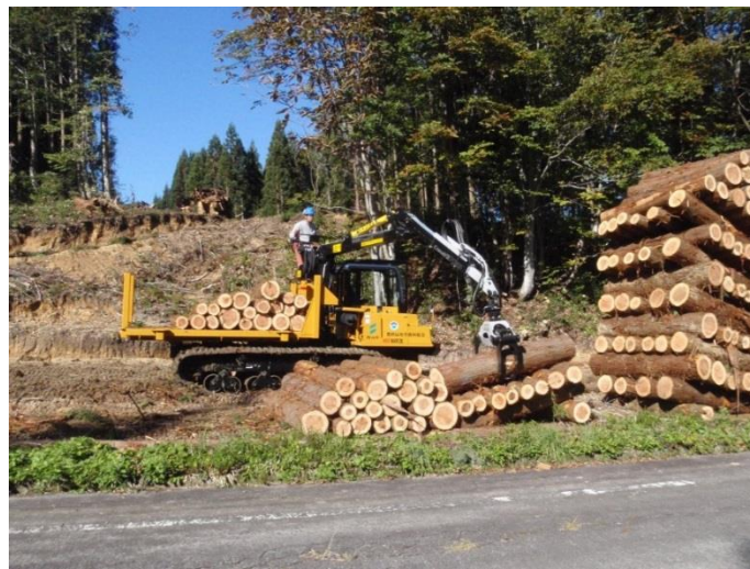
写真 5-4-7 フォワーダによる積み下ろし・巻立て
