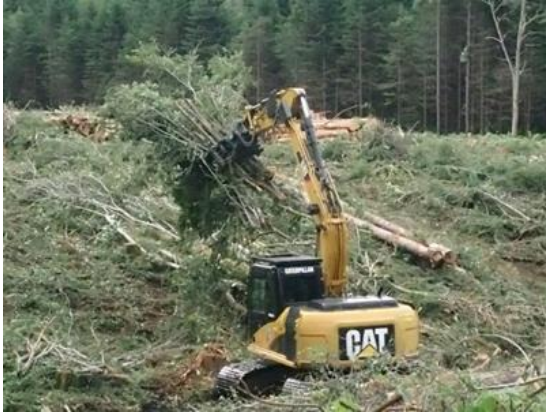
写真 5-3-8 グラップル（左）及びグラップルレーキ（右）による地拵え作業
