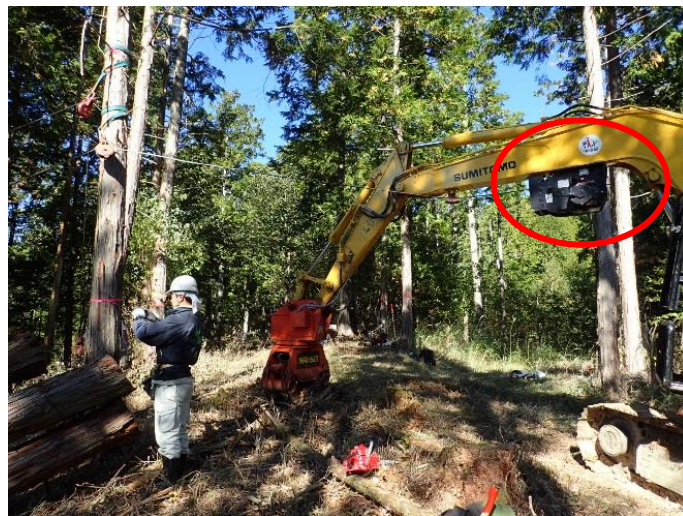
写真 5-5-5 ウインチ付きグラップルを活用した簡易架線
