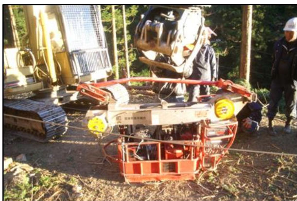
写真 4-3-8 集材に使用したラジキャリー
