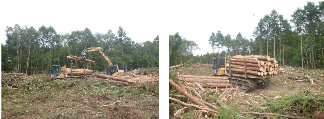
写真 5-3-6 グラップルによる積み込み（左）、フォワーダによる搬出（右）
