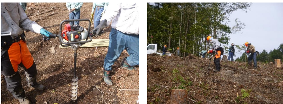
写真 5-3-11 アースオーガー（左）、アースオーガーによる穴あけ作業（右）
