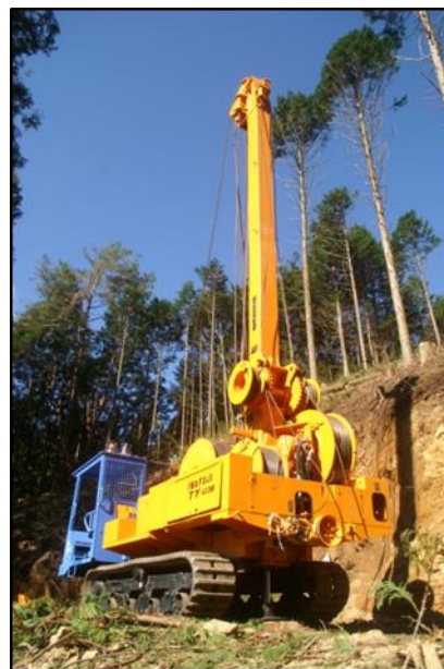
写真 4-3-9 集材に使用したタワーヤード
