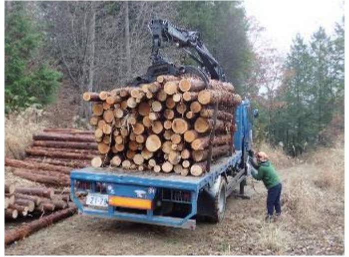
【搬出】 グラップル付フォワーダによる搬出（左）、グラップル付トラックによる搬出（右）
