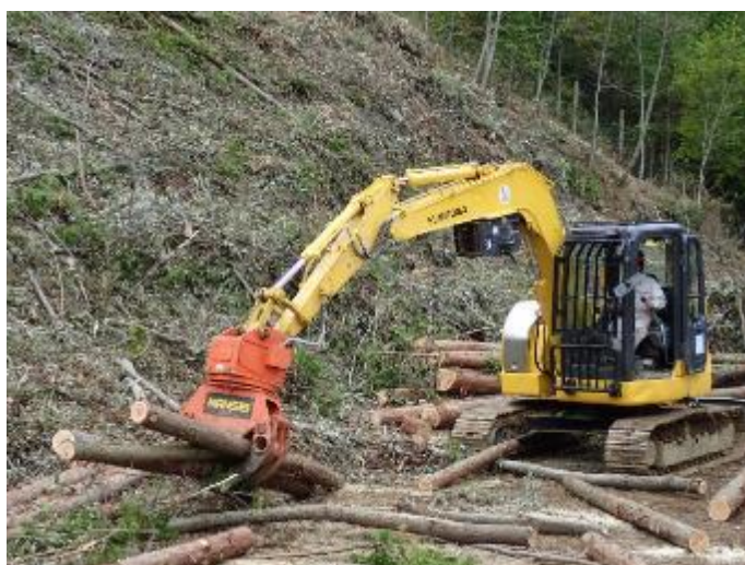
【伐倒】チェーンソーによる伐倒（左上）、【木寄せ】簡易架線を作設しての木寄せ（右上）、【造材】グラップルとチェーンソーによる造材（左下・右下）
