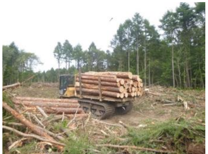
【伐倒】フェラバンチャによる伐倒（左上段）、ハーベスタによる伐倒（右上段）、【木寄せ】グラップルによる木寄せ（左中段・右中段）、【造材】ハーベスタによる造材（左下段）、【搬出】フォワーダによる搬出（右下段）
