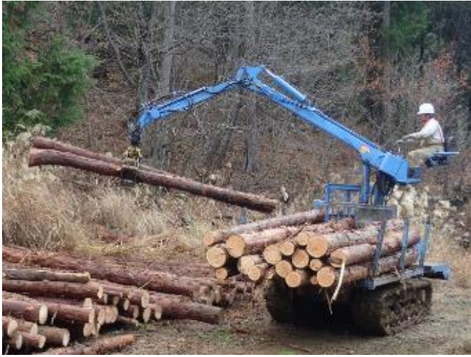
【搬出】 グラップル付フォワーダによる搬出（左）、グラップル付トラックによる搬出（右）
