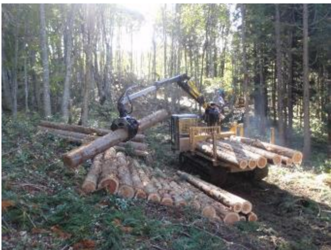
【伐倒】チェーンソーによる伐倒（左上段）、【木寄せ】グラップルによる木寄せ（右上段）、【造材】グラップルとチェーンソーによる造材（左中段・右中段）、【搬出】グラップル付フォワーダによる搬出（左下段・右下段）
