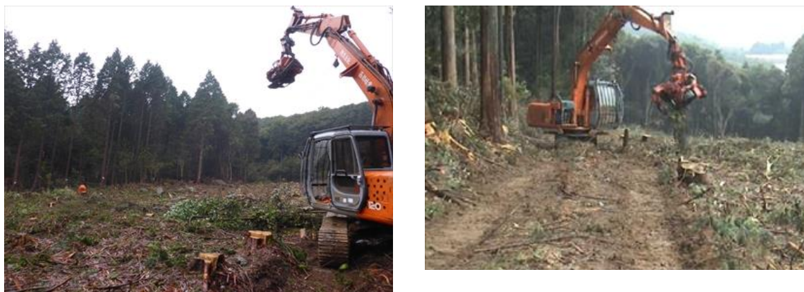
写真 4.23 ハーベスタとウインチを用いた地拵えの状況 (H26 年度報告書より)
