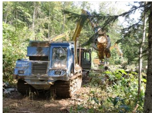
④フォワーダ 積み込み用のグラップルが常備
