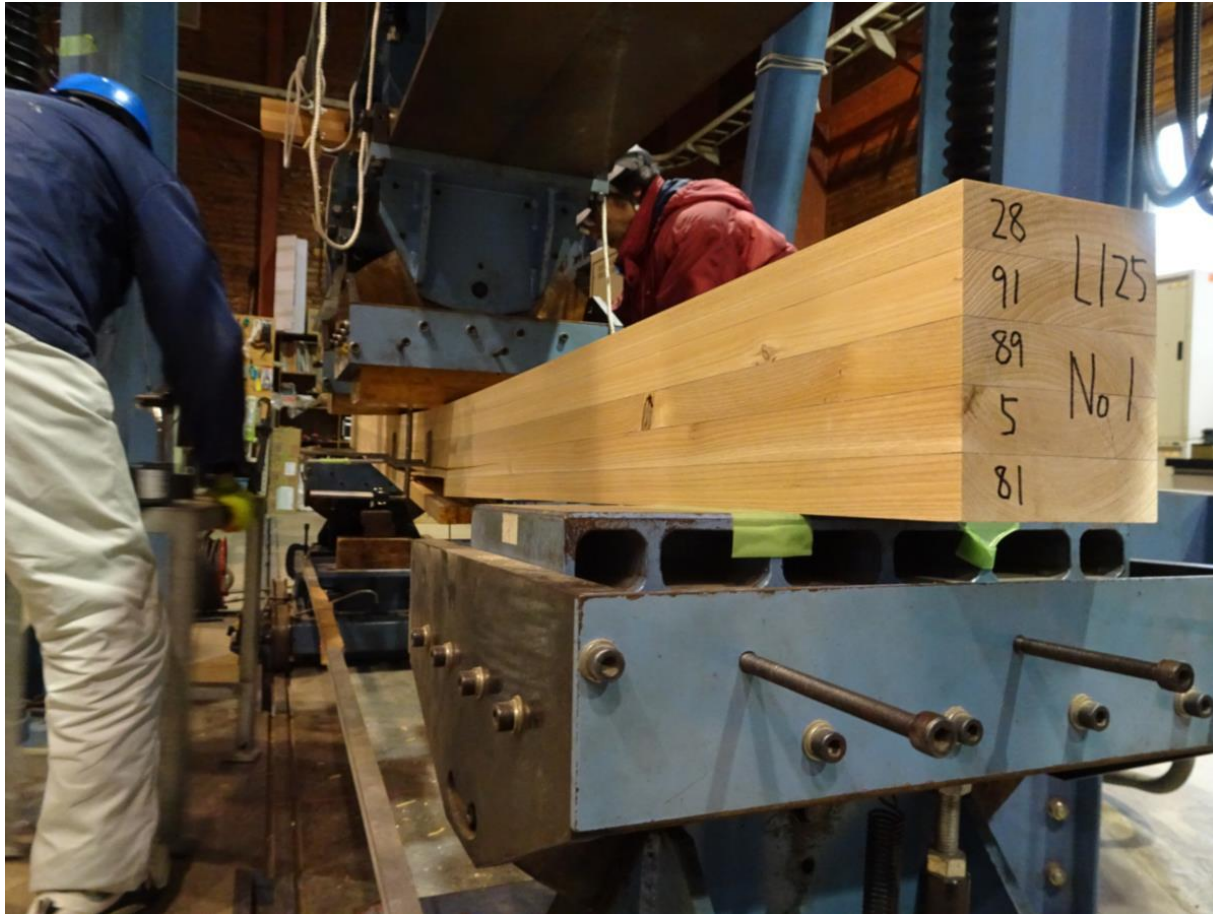
試作した集成材の強度試験
