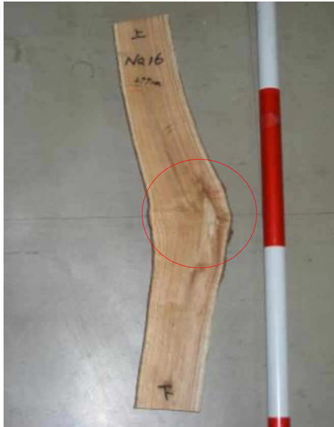
枝打ち後の断面
