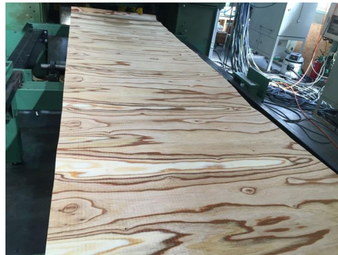
切削されたセンダン単板(心材部) 34
