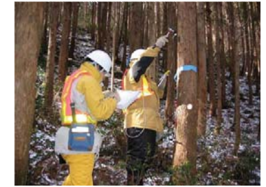
立木状態で材質の測定 (ファコップで簡単にヤング率の指標を測定)
