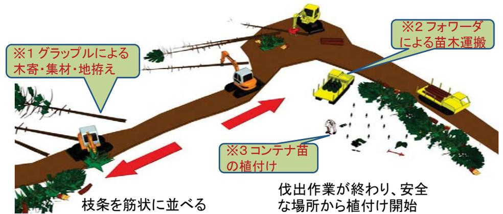
従来の地拵や植付の作業方法を抜本的に見直し、車両系伐出機械を活用して伐採・搬出～地拵～植付を連携して同時に行い、造林コストの低減を図るもの
