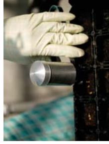
乾いたタネ用。中のダイヤルによって穴のサイズが変わり、タネのサイズ、まく数を調整できる。 300〜600セル/1時間
