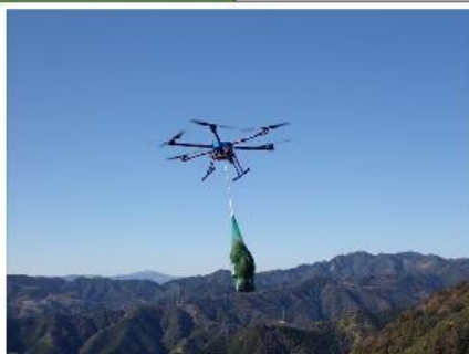
機体：6枚羽で安定した飛行を実現
