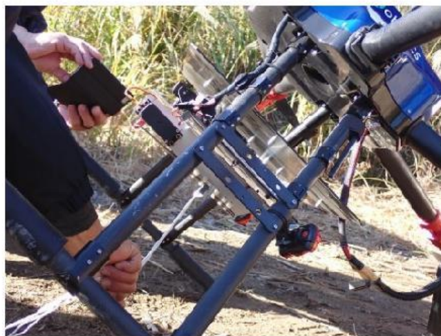
写真 4-5 遠隔操作で運搬物を切り離す機種 (ciDrone/ciRobotics 社)
