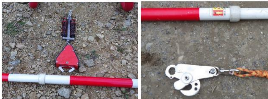
写真 4-3 荷下ろしの際に操縦者の操作で切離しができる自動フック
