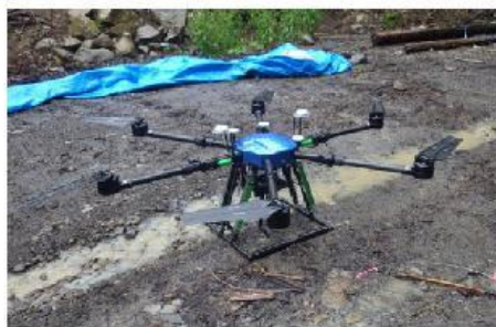
機体：6枚羽による安定飛行が可能
