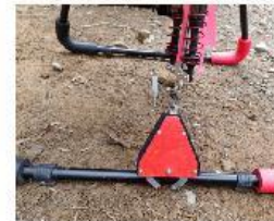
自動フックにより荷下ろしに係る補助者が不要
