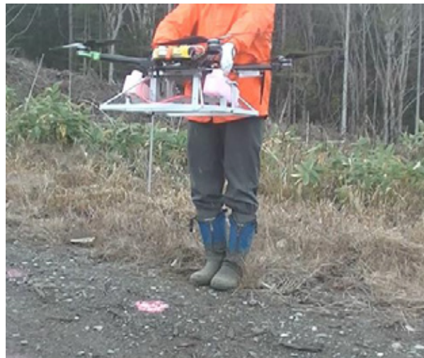
写真 6-2 マーキング液の滴下状況（北海道当別地区）
