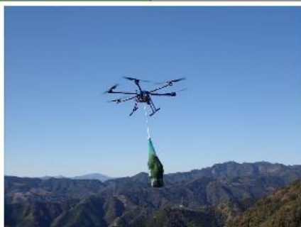
機体：6枚羽で安定した飛行を実現
