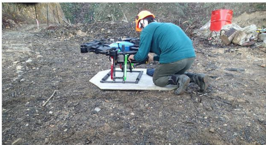
写真 5-10 バッテリー交換の様子
