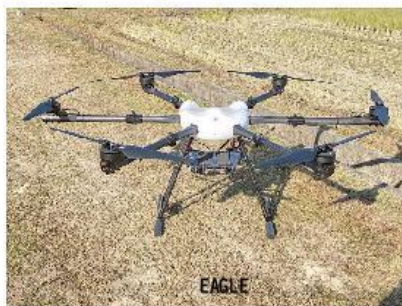
機体：フライトコントローラを独自開発し、風に強い
