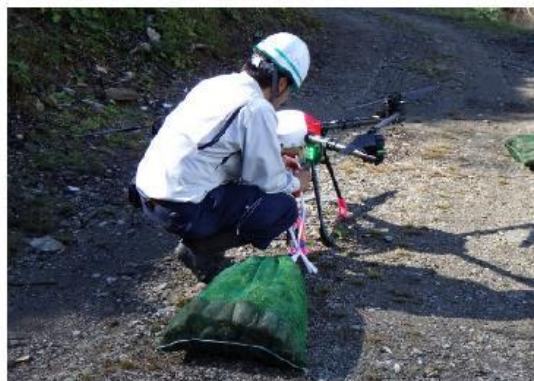
写真 5-6 荷掛作業の様子
