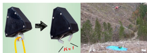
図-3. 専用フックと苗木離脱の様子
