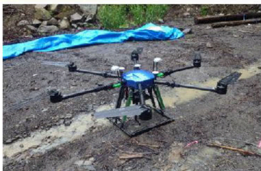
機体：6枚羽による安定飛行が可能
