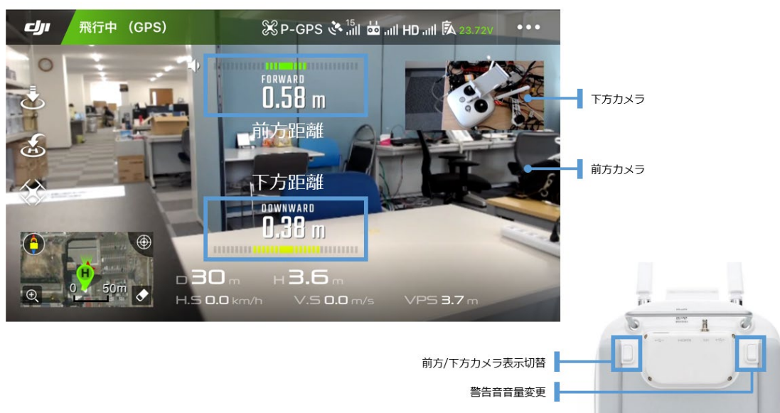
図1. 前方及び下方の距離センサの表示画面イメージ
