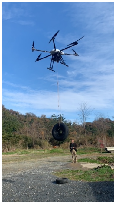
鉄ホイールのタイヤを吊って飛ぶ EAGLE24 (重量 23 kg)
