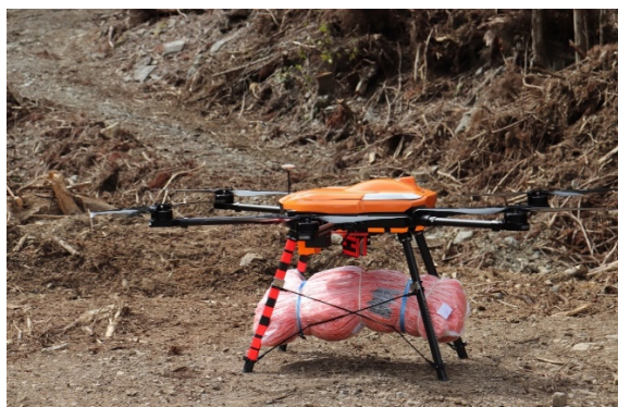
写真2.防鹿ネット運搬中のドローン
