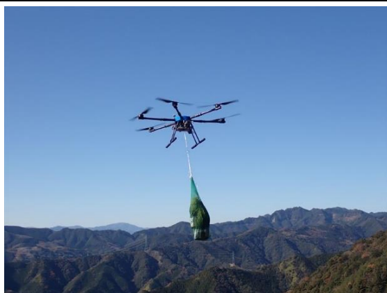
機体：6枚羽で安定した飛行を実現
