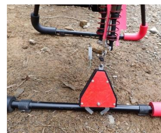
自動フックにより荷下ろしに係る作業員が必要ない
