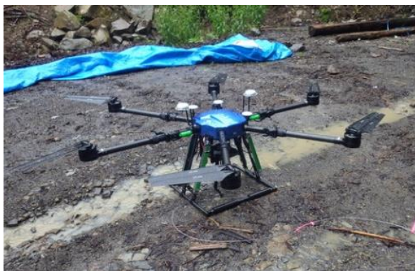
機体：6枚羽による安定飛行が可能
