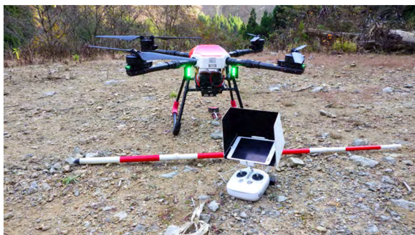
図3-18 森飛ウインチ型：機体の大きさ 980mm（プロペラ除く）
