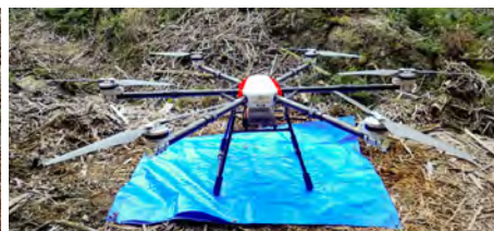
森飛25：2130mm/約20kg ※機体寸法（プロペラ除く）
