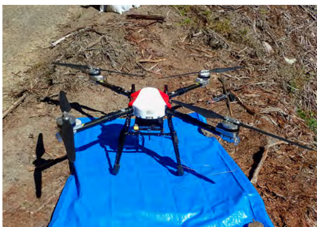
図3-20 森飛15：1042mm (プロペラ除く)
