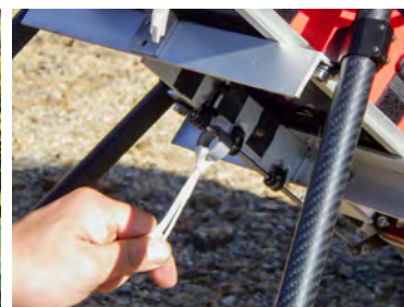
苗木の紐先につけたリングをドローンにつけ、 遠隔操作でリングごと切り離す
