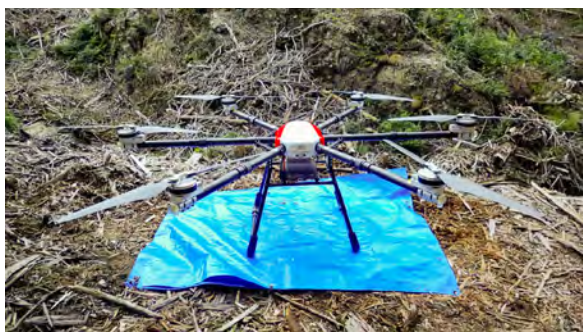
図3-24 森飛25 : 2130mm (プロペラ除く)
