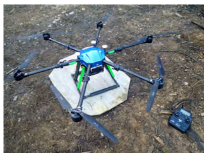
ITAKISO：1730mm/19kg ※機体寸法（プロペラ除く）
