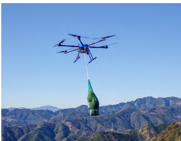
ドローンは1回の運搬量は少ないが早く運搬できる
