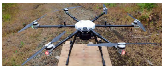
XYZ20/Motte2：2760mm/26.5kg （本体17.5kg、バッテリー9kg）
