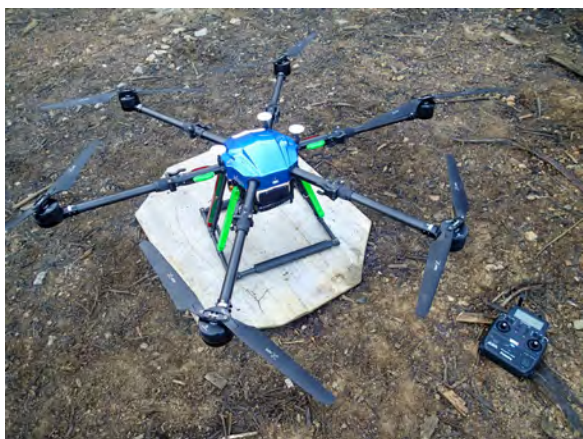
図3-26 ITAKISO : 1730mm (プロペラ除く)
