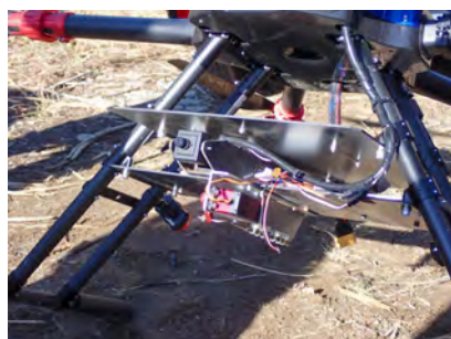
カメラは水平・中間・真下の3段階に角度調整可能
