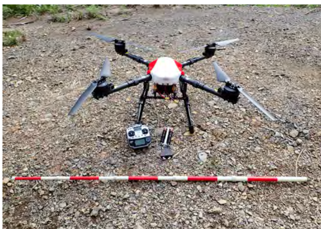
図3-19 森飛2オペ型：980mm (プロペラ除く)
