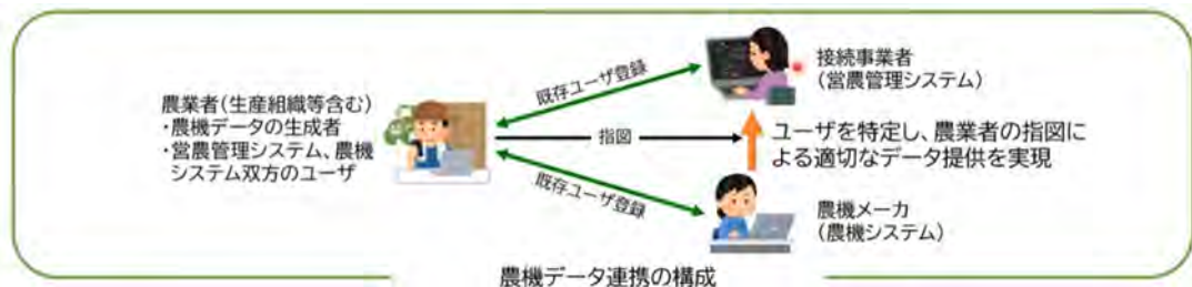
図4 農機データ連携における認証・認可の仕組み
