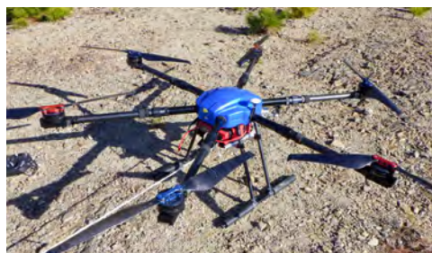
ARRIS E616：1,000mm/ 約19.5kg（バッテリー含む）
