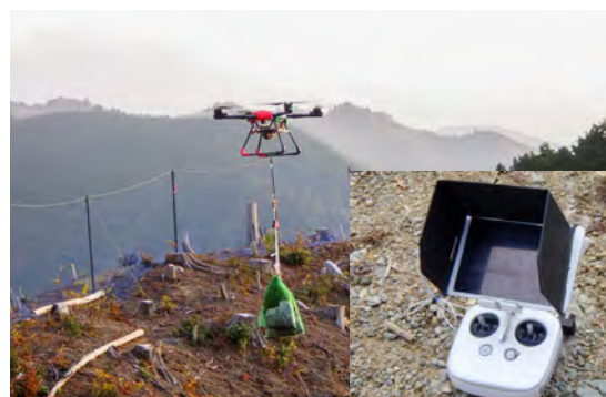
図5-6 1オペの機種のプロポ（右下）と荷下ろしの様子
