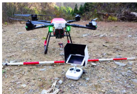
森飛1オペ（ウインチ）タイプ： 980mm/10.7kg（バッテリー除く）
