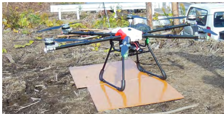
森飛25：2130mm/約20kg ※機体寸法（プロペラ除く）
