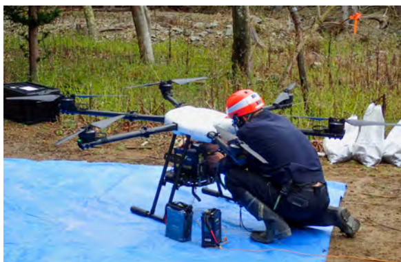
図5-11 バッテリー交換の様子
