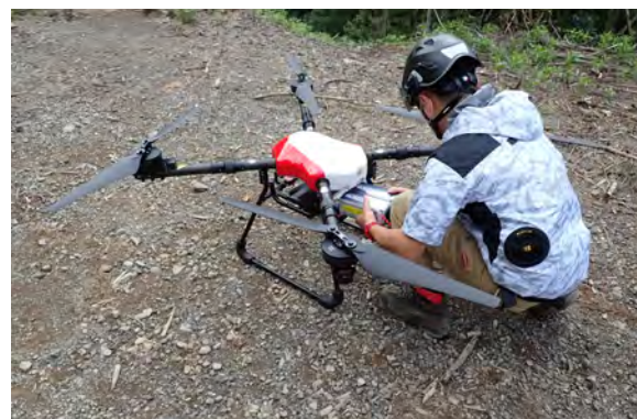
図5-11 バッテリー交換の様子
