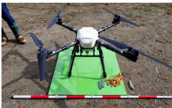
M1000：980mm/10.7kg ※機体寸法（プロペラ、バッテリー除く）
