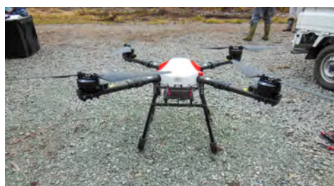
森飛2オペ型：980mm/約15kg ※機体寸法（プロペラ除く）
