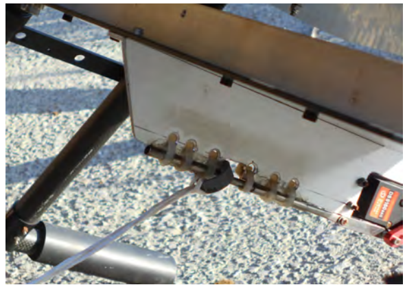
図3-6 遠隔操作で運搬物を切離す機種 (右)
