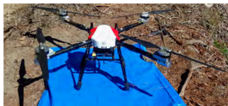
森飛15：1042mm/16.7kg ※機体寸法（プロペラ除く）
