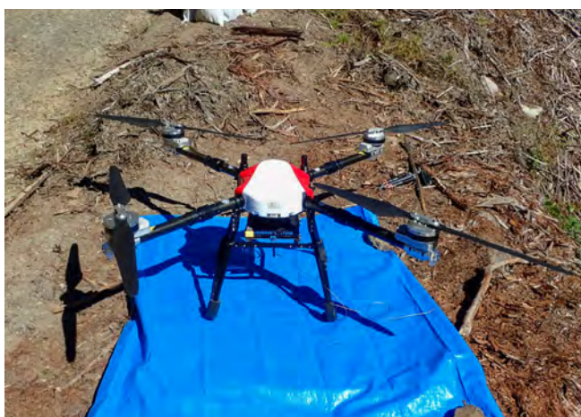
図3-20 森飛15：1042mm (プロペラ除く)
