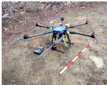
UKN5：1730mm/10kg ※機体寸法（プロペラ、バッテリー除く）
