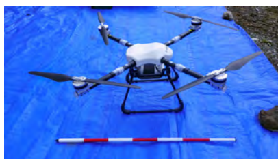
森飛15：1042mm/16.7kg ※機体寸法（プロペラ除く）
