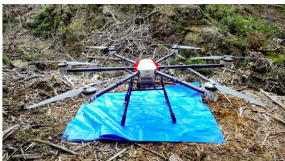
図3-24 森飛25 : 2130mm (プロペラ除く)
