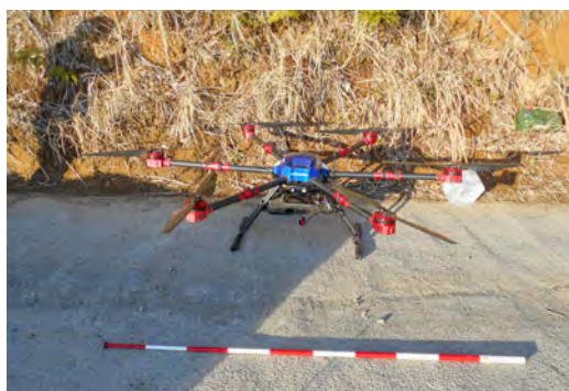
ciDrone TR-22：2000mm/20.0kg 苗木を吊るす紐を遠隔操作で切り離し
