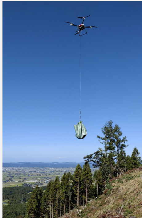
ドローンによる苗木運搬の様子
