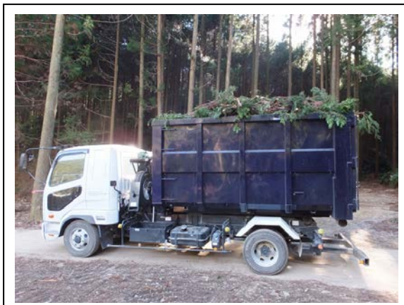
【アームロール車による運搬】 (アームロール車による運搬)
