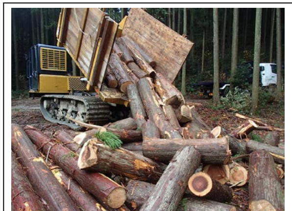
【フォワーダに工夫を施し運搬】 (フォワーダによる根株材等の運搬)
