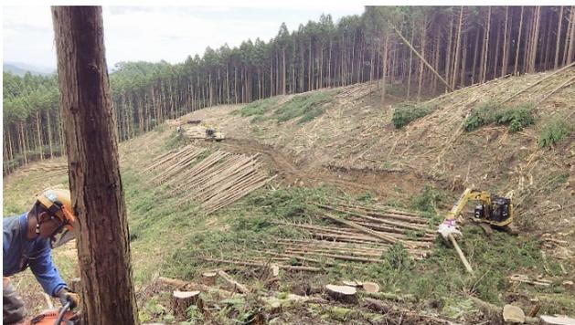
【皆伐施業の状況:(左手前)チェーンソー伐倒、(右手前)フェラーバンチャで作業道作設と材の集積をし、(左奥)ハーベスタにより造材】
