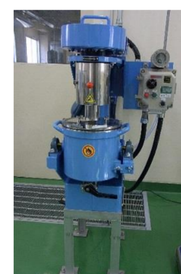
ボールミルユニット 直径約10mmのジルコニアボールを衝突させ、繊維をナノ化する
