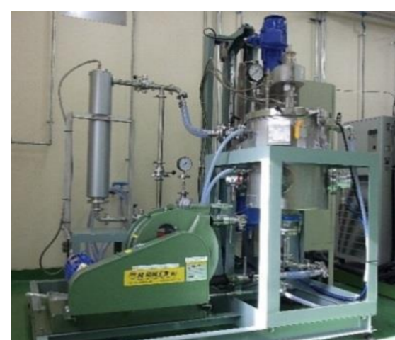
前処理反応槽 酵素反応(と超音波の衝撃)によりパルプ繊維をほぐす
