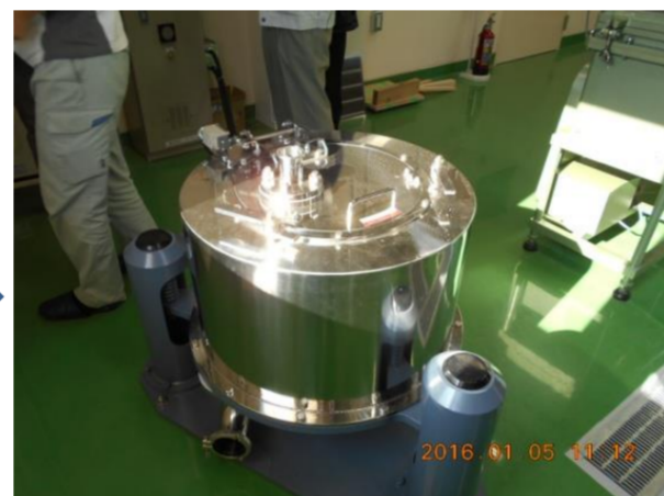
遠心分離機 ソーダ蒸解で発生する黒液を分離する
