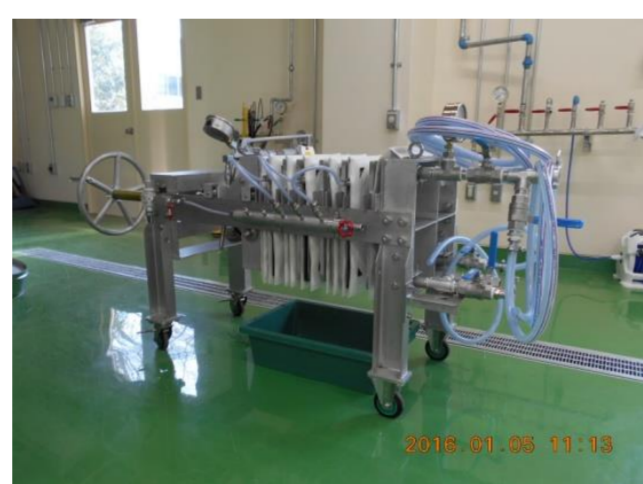
フィルタープレス 漂白パルプの洗浄・脱水
