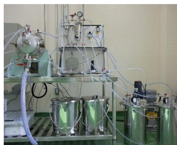
セラミックフィルター濃縮機 セルロースナノファイバー液の濃縮や溶媒置換
