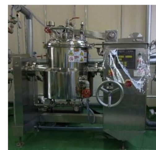
真空加熱濃縮機 セルロースナノファイバー液の濃縮
