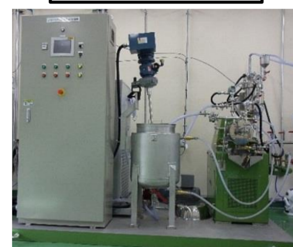
ビーズミルユニット 処理液中に直径1mmのジルコニアビーズを入れて、互いに衝突させ、繊維をナノ化する
