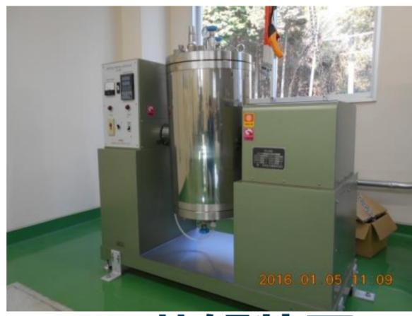
55L蒸解装置 CNF原料パルプ製造
