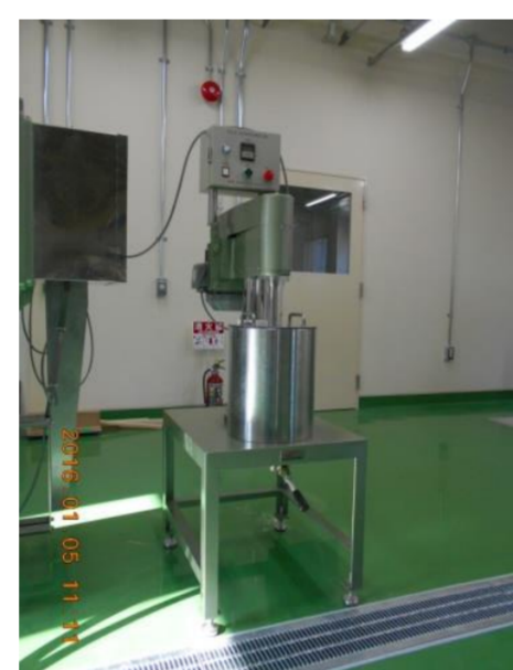
蒸解チップ分離機 蒸解チップをパルプ化する
