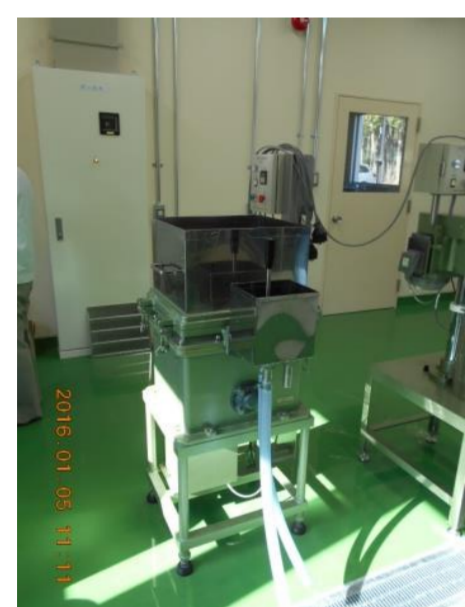
フラットスクリーン パルプ中の未蒸解残渣を除去 パルプの洗浄
