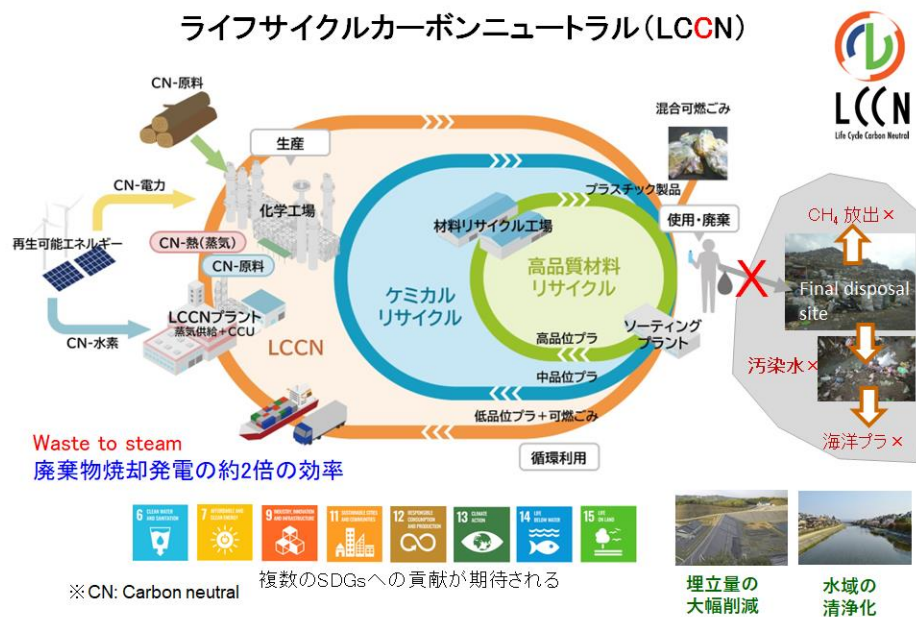
図9 材料（マテリアル）リサイクル、ケミカルリサイクル、焼却・蒸気供給とCCUのシステム [20]
