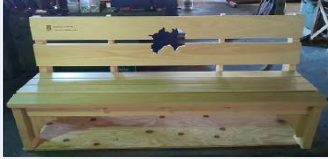
【下塗り剤を試験施工済み四国JR駅ベンチ】 写真提供：玄々化学工業(株)
