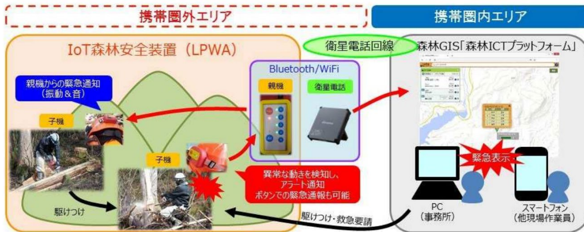
LPWA 及び衛星回線を活用した林業安全管理システム
