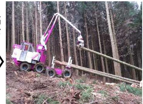
傾斜地での伐倒・搬出作業の様子
