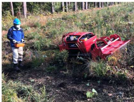
遠隔操作による下刈り作業
