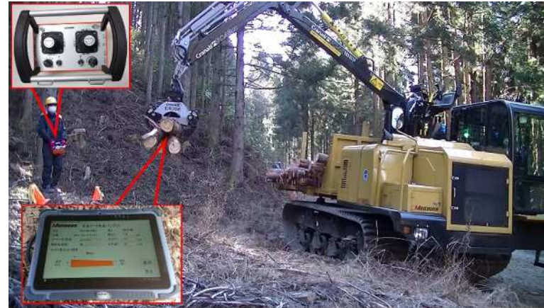
遠隔操作による材の積込作業 掴んだ丸太の重量データはタブレットに自動記録
