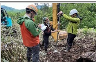
機械稼働前後での土壌硬度や含水率を測定
