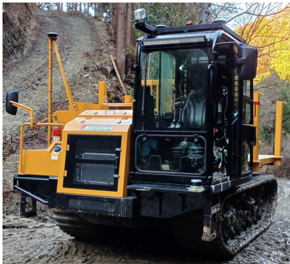
電子制御化されたフォワーダをベースマシンとして、自動運転システムやGNSSアンテナなどを搭載
