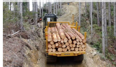
丸太を積載して上り坂を自動走行 (R5年度事業成果より)
