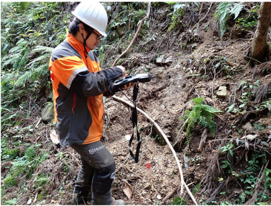
【写真3 GNSS測量機による測量作業】
