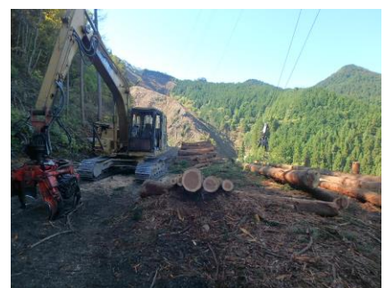
【集材機による全幹集材とプロセッサによる玉切り】
