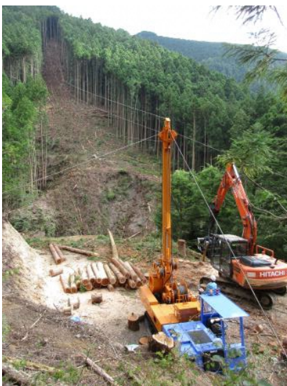
【タワーヤーダの設置状況】
