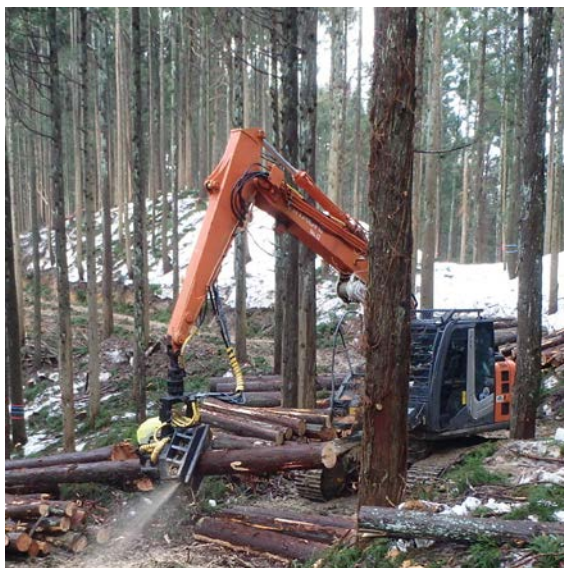
作業路でのプロセッサを使った造材
