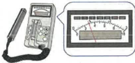
[図 2-10] 線量の測定方法 (NaI シンチレーション式サーベイメータ)
